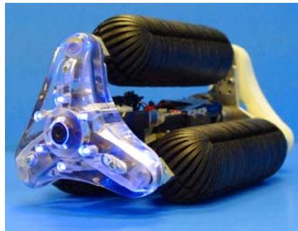
図4：対称配置構造型円形断面クローラロボット
